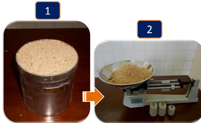
Gambar 3.3 : Uji Kualitas Bahan Pakan dengan cara Bulk Dencity
