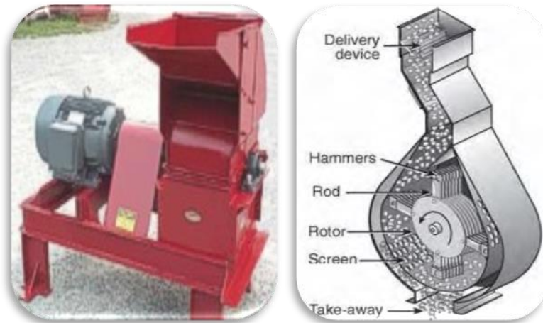
Gambar 39. Hammermill dan Penampang Bagian Dalamnya.
