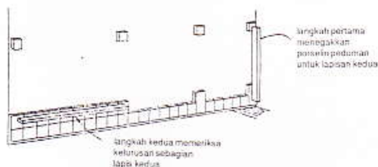
Gambar 72. Cara memeriksa pemasangan ubin porselin pada badan dinding.
