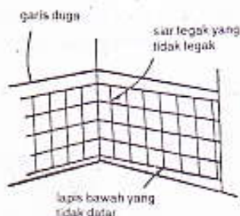
Gambar 64. Bentuk siar akibat pemasangan mistar yang miring.
