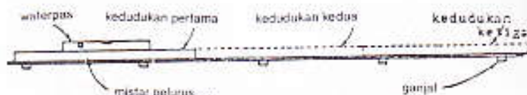
Gambar 67. Pemasangan mistar penahan dengan bantuan mistar lurus dan "waterpas"
