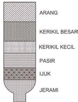
Sumber: Dokumen Kemdikbud Gambar 2.7. Contoh penyaringan air
