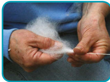
Gambar 1.18 Pemintalan kapas menjadi benang secara manual.
