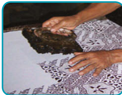
Gambar 2.33 Teknik cap pada proses pembuatan batik.
