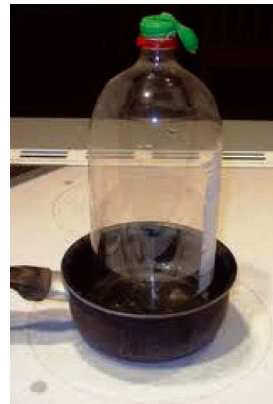
Sumber: Dok. Kemdikbud Gambar 5.6. Pemuaian gas di dalam botol plastik
