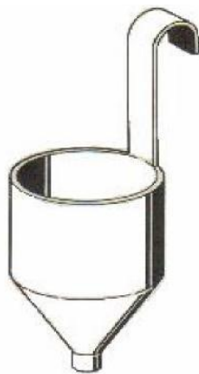
Gambar 37: Mangkuk kekentalan, untuk mengukur kekentalan cat
