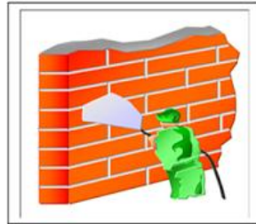
Gambar 19 Penyiraman Dinding Sumber: Edwin, 2014
