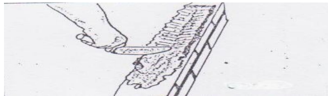
Gambar 66. Cara membuat alur adukan
