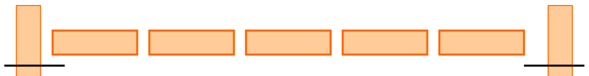
Gambar 73. Cara menata bata memanjang tanpa spesi
