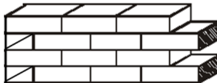
Gambar 46. Pasangan bentang \frac{1}{2} bata
