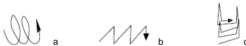
Gambar 6.15. Bentuk gerakan elektroda (Sumber : Wiryosumarto, 2004, hal : 222)
