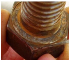
Gambar 7.2 Crevice corrosion pada baut
