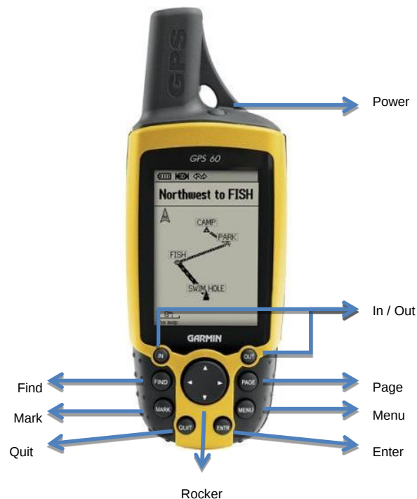
Gambar 19. Tampak Depan GPS Garmin 60
