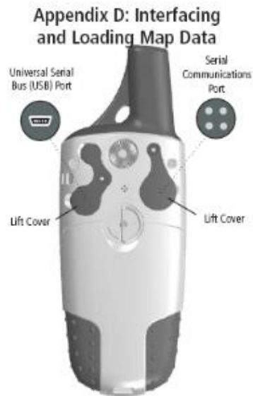
Gambar 30. GPS 60 tampak belakang, lobang/port USB
