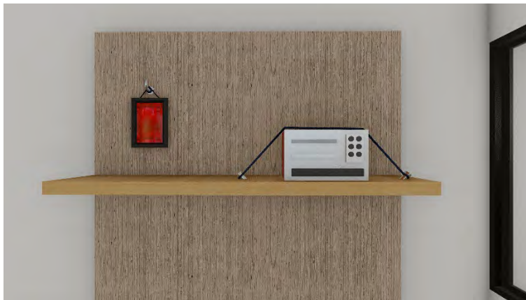
Gambar 7. Komponen non-struktur harus diberi pengaku
