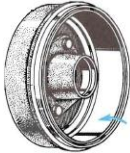
Gambar 4. Jenis tromol internal.
