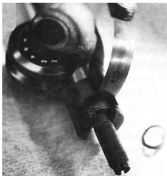
Gambar 199. Poros sktor dengan baut penyetel back-lash.
