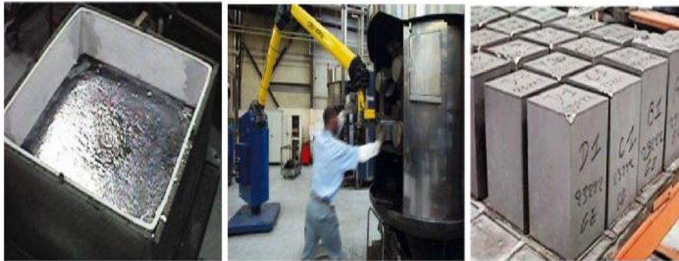
Gambar 4: Metoda Casting Pembuatan Bahan Polikristal
