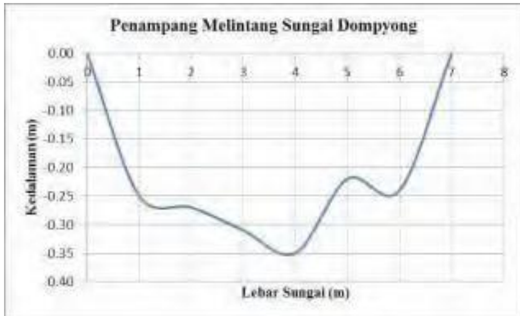
Gambar 4. Penampang melintang sungai Dompoyong hasil pengukuran
