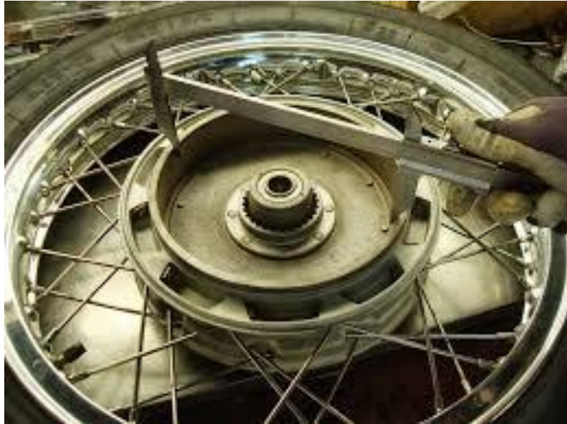
Gambar 2.13 Pengukuran diameter tromol
