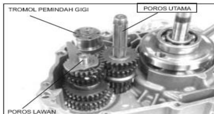
Gambar 2.45 Melepas Poros Transmisi
