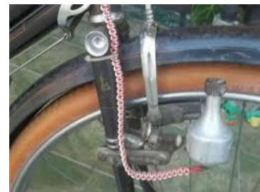
Gambar 4.3. Dinamo Sepeda digunakan untuk menyalakan lampu
