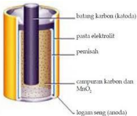
Gambar 4.1. Baterai dan Bagian-Bagiannya
