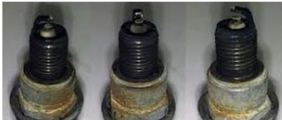
Gb. II.A.32 Warna hasil pembakaran pada ujung insulator dan elektroda busi
