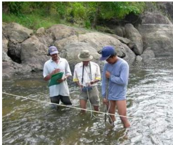
Gambar 7.4 Pelaksanaan pengukuran debit air menggunakan current meter di lapangan
