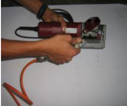
Gambar 6.3.13. Posisi melubang miring 45°
