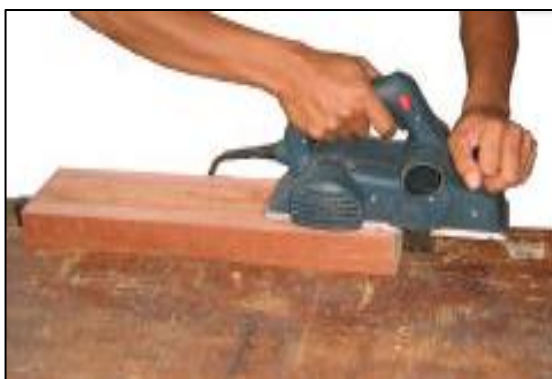
Gambar 3.1.4. Pengetaman akhir dengan mesin ketam tangan listrik
