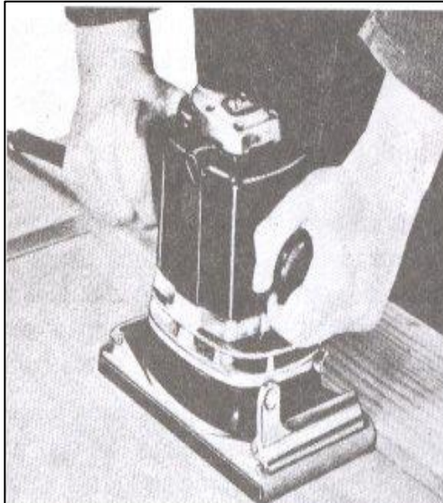
Gambar 4.1.7. Mengampelas Bidang Datar
