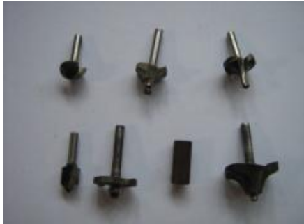
Gambar 5.2.3. Jenis pisau profil mesin trimer.
