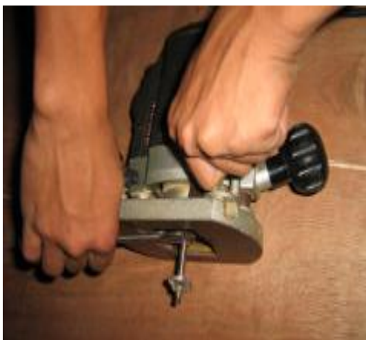
Gambar 5.1.4. Memasang pisau router
