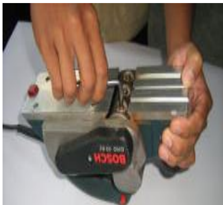
Gambar 3.2.1. Mengetam dengan stationer
