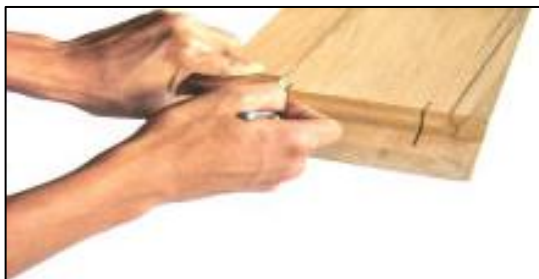
Gambar 6.3.8. Melukis posisi lamello
