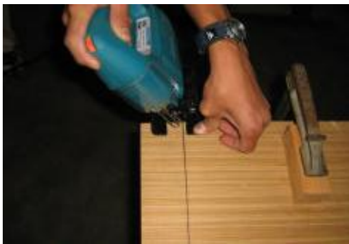
Gambar 6.2.8. Memotong miring dengan benda kerja diklem
