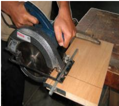
Gambar 6.1.5. Memotong dengan penghantar
