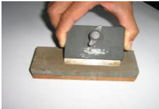
Gambar 3.2.3. Posisi mengasah mata pisau ketam
