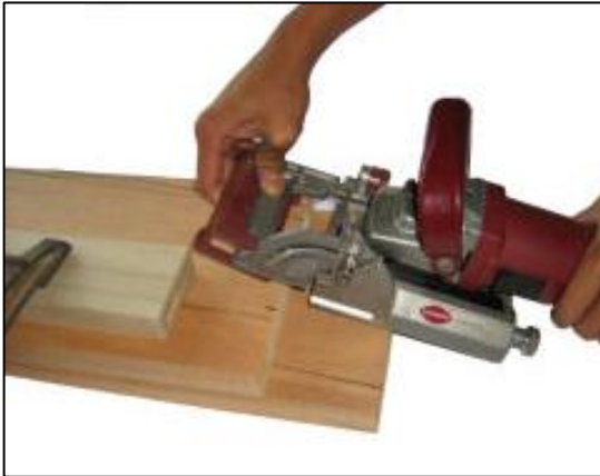
Gambar 6.3.11. Penggunaan alat bantu mesin lamello
