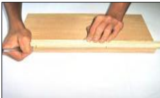
Gambar 6.3.5. Melukis dengan mal (sablon)
