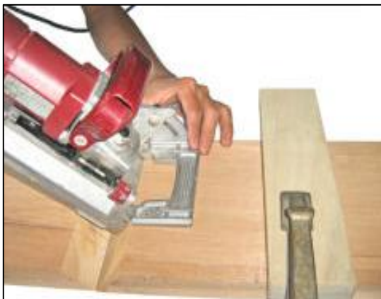
Gambar 6.3.12. Posisi melubang Miring 45°
