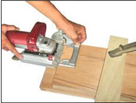
Gambar 6.3.9. Penggunaan mesin lamello untuk melubang datar
