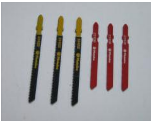
Gambar 6.2.4. Jenis pisau mesin gergaji jig
