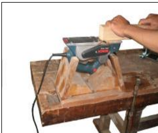
Gambar 3.1.7. Mengetam dengan stationer
