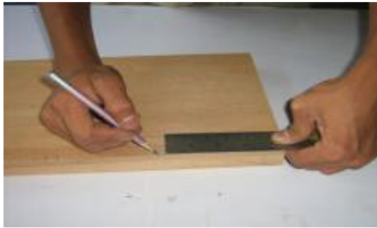
Gambar 6.3.4. Melukis posisi lamello
