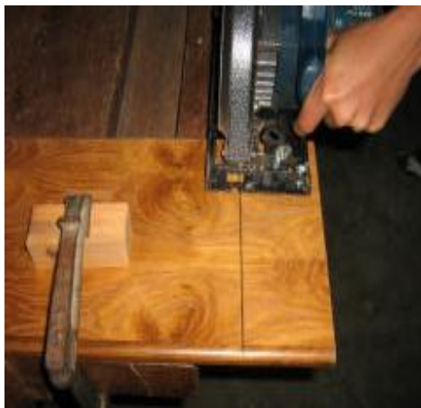
Gambar 6.1.5. Memotong tanpa Penghantar potong
