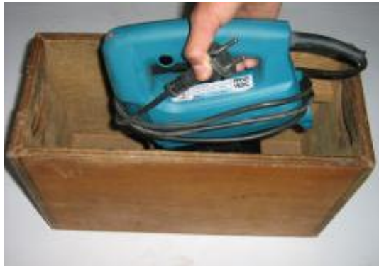
Gambar 6.2.13. Penyimpanan mesin Jig saw
