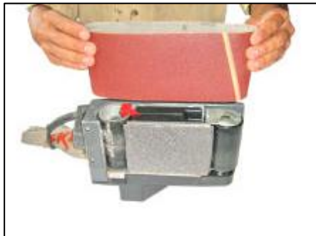
Gambar 4.2.4. Mengganti kertas gosok mesin ampelas ban
