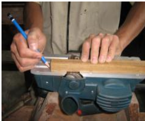
Gambar 3.2.2. Penyetelan ketinggian mata pisau ketam
