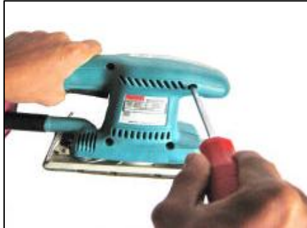
Gambar 4.1.9. Cara membuka Mesin ampelas getar
