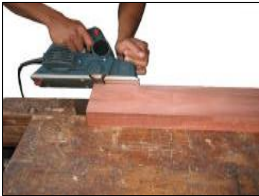
Gambar 3.1.4. Mengetam miring permukaan kayu
