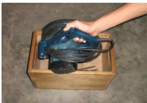
Gambar 6.1.19. Penyimpanan mesin gergaji tangan listrik.
