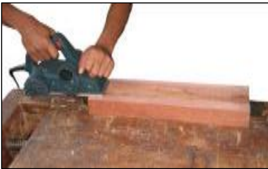
Gambar 3.1.3. Pengetaman awal dengan mesin ketam tangan listrik
