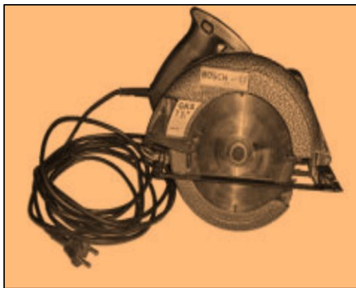
Gambar 6.1.1. Mesin gergaji tangan listrik
