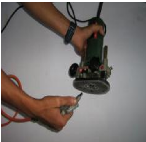
Gambar 5.1.10. Merawat mesin router
