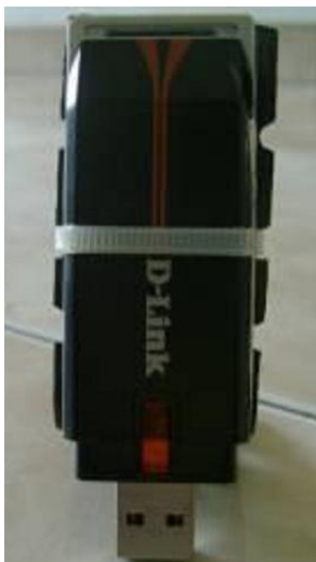
Gambar 5.25. Wireless USB adapter yang diikat pada plat L (non logam)
