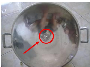
Gambar 5.20. Bagian tengah wajan yang telah di bor
