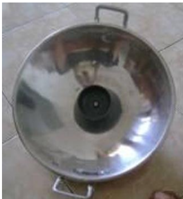
Gambar 5.22. Wajan dan tutup pipa paralon yang telah dibaut
