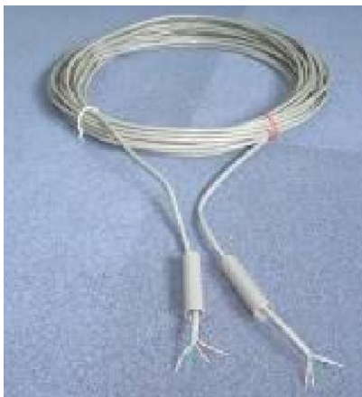
Gambar 5.32. Memasukkan pipa ke kabel sebelum disolder
