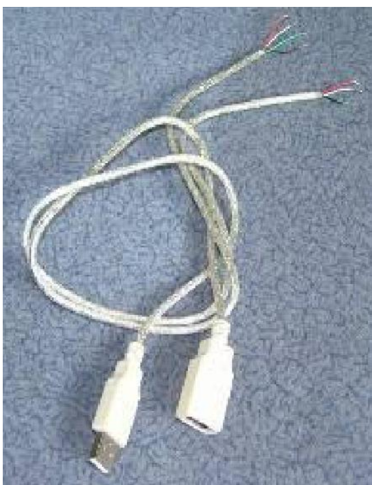
Gambar 5.30. Kabel USB yang dipotong menjadi 2
