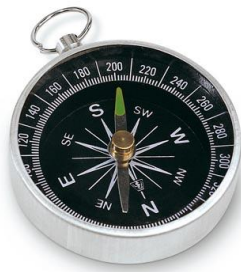
Gambar 1. Kompas sebagai penunjuk arah atau azimuth dalam pengukuran dan pemetaan tanah.
