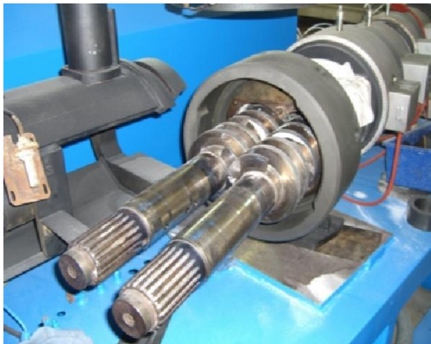
Gambar 30. Ulir ganda pada ekstruder (Sumber : www.exapro.com )
