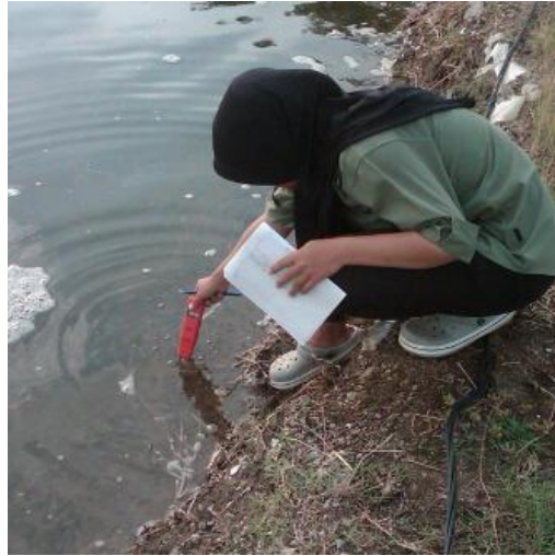
Gambar 64. Pengukuran suhu di kolam/tambak
