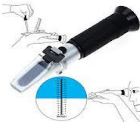
Gambar 30. Pengukuran salinitas perairan dengan refraktometer
