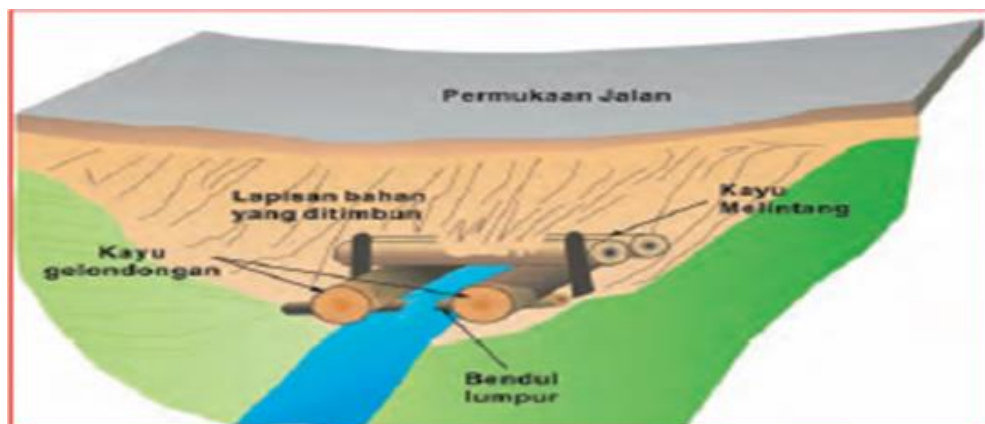
Gambar 39. Sketsa gorong-gorong terbuat dari kayu log.
