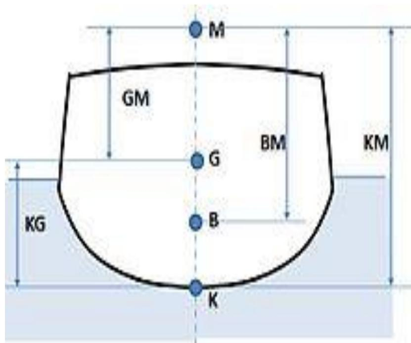
**Gambar 12. Ukuran/formula hubungan titik-titik pada stabilitas kapal**
