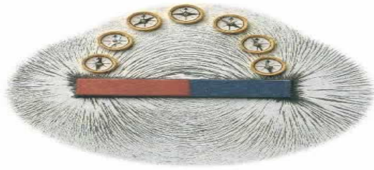
Gambar 2-1.2 Reprerentasi garis-garis gaya dan garis-garis induksi magnet pada suatu batang magnet
