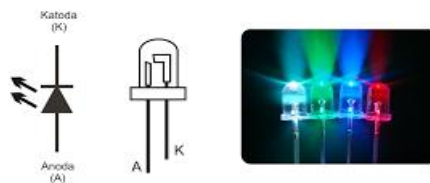
Gambar 3-2.7. Konstruksi dan simbol LED
