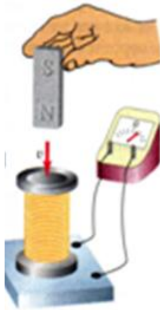
Gambar 2-2.4. Batang magnet permanen yang digerakkan
