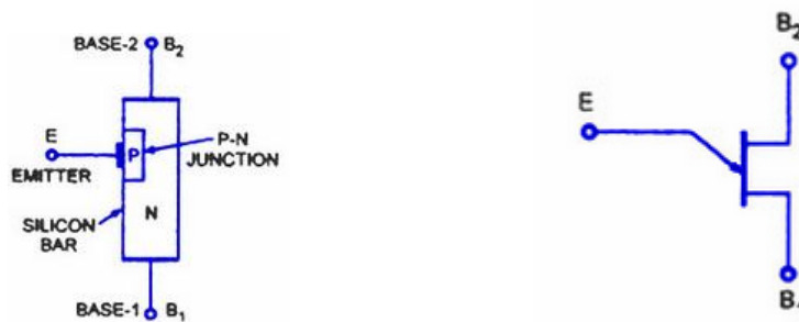
Gambar 3-4.15 UJT a. Susunan UJT, b . Lambang skematik
