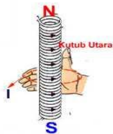
Gambar 2-1.10 Menentukan kutub Solenoid dengan metode tangan kanan
