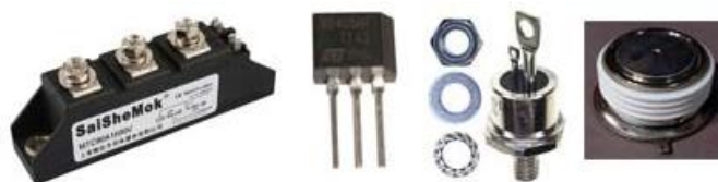
Gambar 3-4.4 Bentuk Fisik SCR
