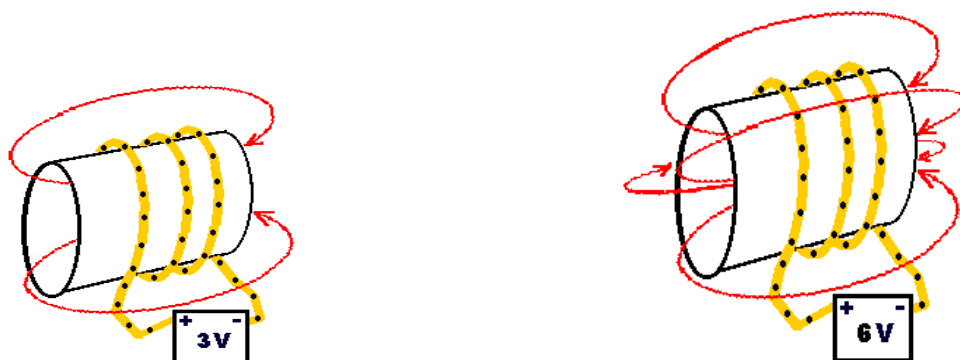
Gambar 2-2.2a kumparan dialiri listrik 3 volt DC dan 6 volt DC
