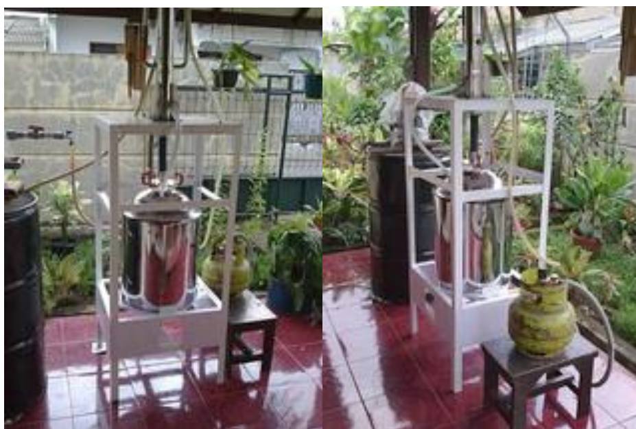
Gambar 16. Penyulingan (distilasi) etanol menggunakandistillator model kolom reflux
