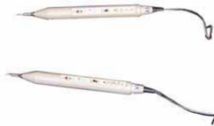
Gambar 58. Pembangkit Pulsa Logik yang Dapat Memberikan Sinyal pada Rangkaian
