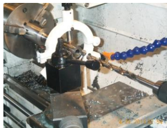
Gambar 1. 18 Proses pengeboran pada mesin bubut
