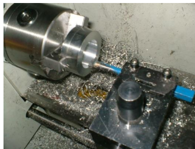
Gambar 1. 19 Proses pembubutan diameter dalam
