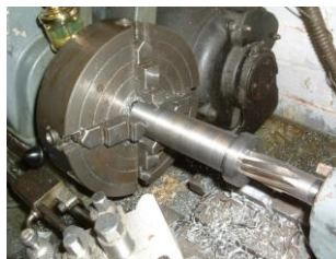
Gambar 1. 24 Contoh pemasangan rimer tangkai tirus pada kepala lepas dan penggunaan pada mesin bubut
