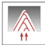
Gambar 1. 13 Metoda pemotongan ulir dengan cara zig-zag
