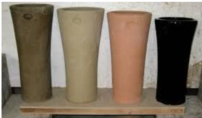
Gambar 25. Perubahan Fisik Karena Proses Pembakaran (Sumber: www.morrisandjamesmatakana.blogspot.com )
