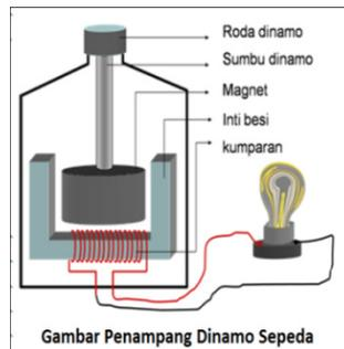
Gambar 31. Cara kerja dinamo sepeda
