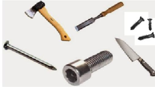
Gambar 40. Peralatan yang memanfaatkan prinsip bidang miring
