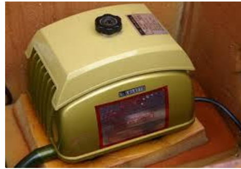
Gambar 32. Blower / Aerator untuk Pembenihan Ikan
