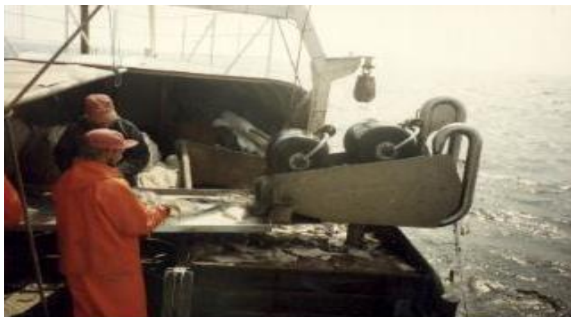
Gambar 115. Hauling gillnet menggunakan net hauler
