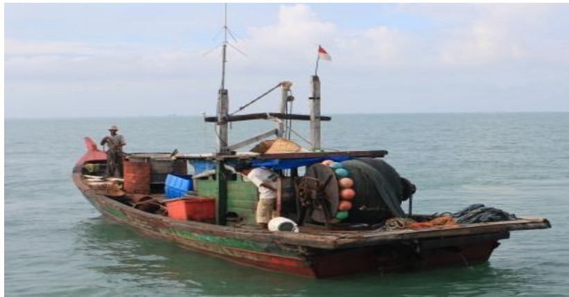
Gambar 112. Kapal gillnet dengan drum net
