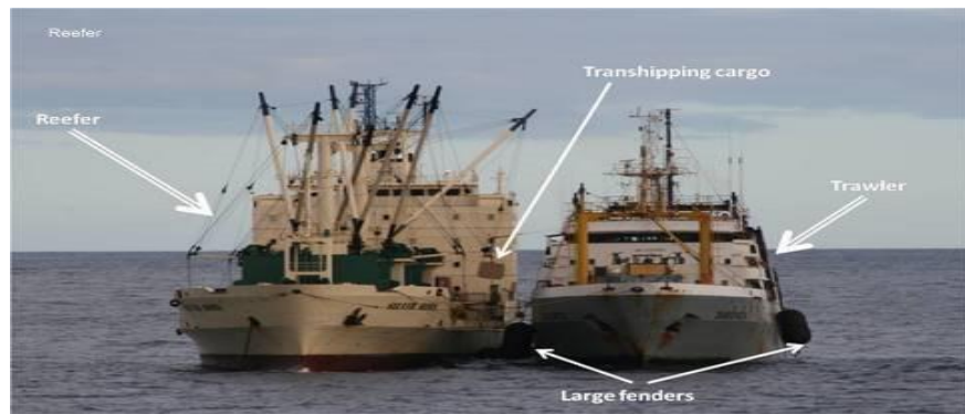
Gambar 193. Sebuah kapal trawl sedang merapat pada kapal reefer untuk memindahkan hasil tangkapan
