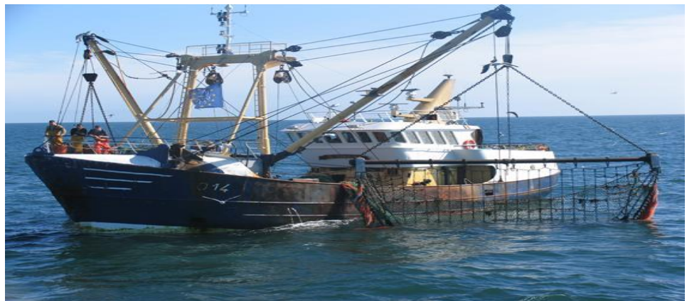
Gambar 141. Kapal beam trawl sedang menaikan alat tangkap
