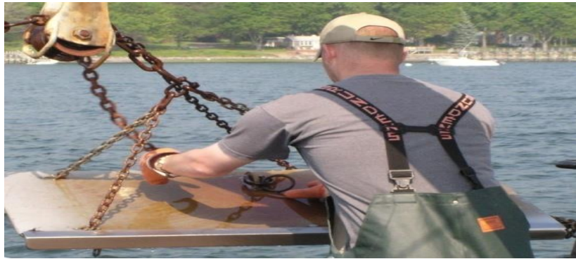
Gambar 213. Seorang awak kapal sedang memasang otterboard
