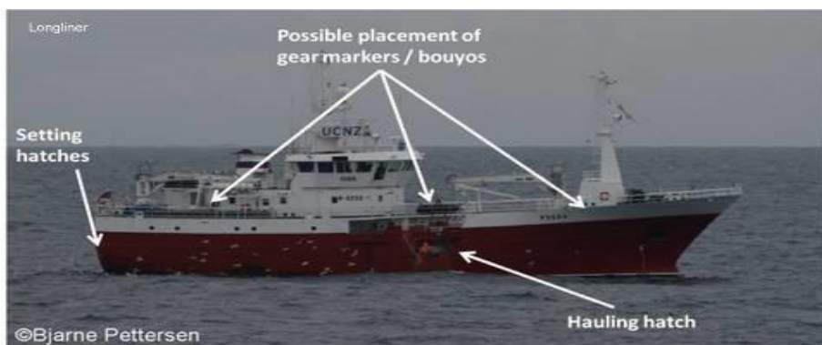
Gambar 173. Lokasi setting dan hauling pada kapal longline
