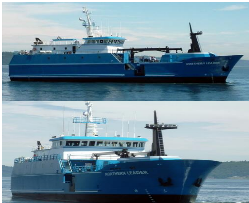
Gambar 175. Kapal longline tuna, 1.600 GT. Panjang 56 m
