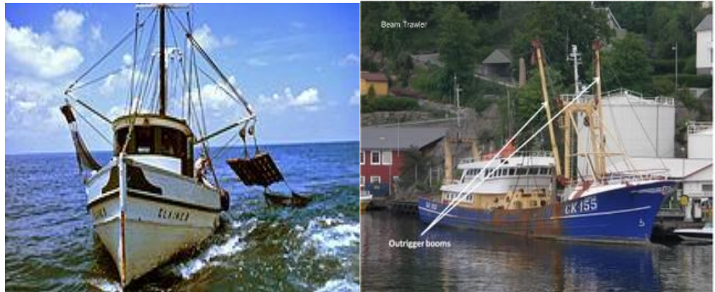
Gambar 146. Kapal trawl udang dengan dua outrigger
