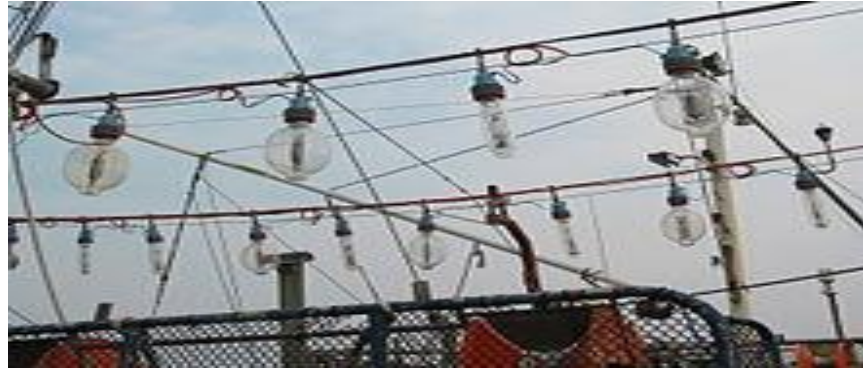
Gambar 167. Rangkaian lampu pada kapal pancing cumi
