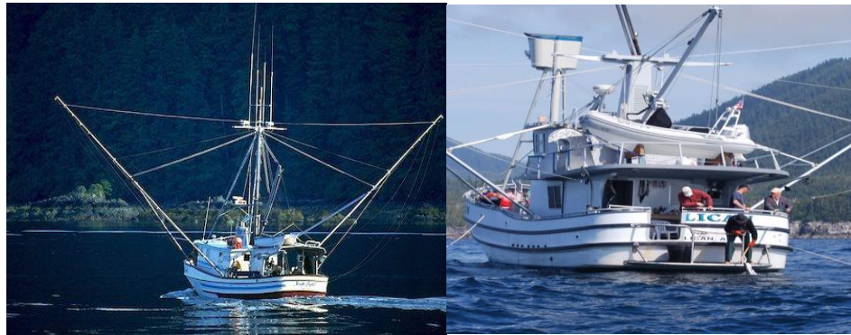
Gambar 162. Kapal trolling dengan boom
