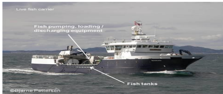
Gambar 194. Kapal pengangkut ikan hidup dengan tangki ikan
