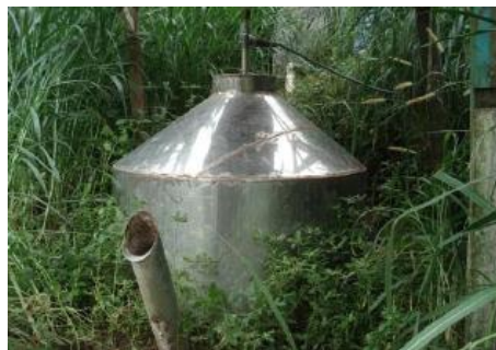
Gambar 31. Reaktor biogas dari lembaran baja
