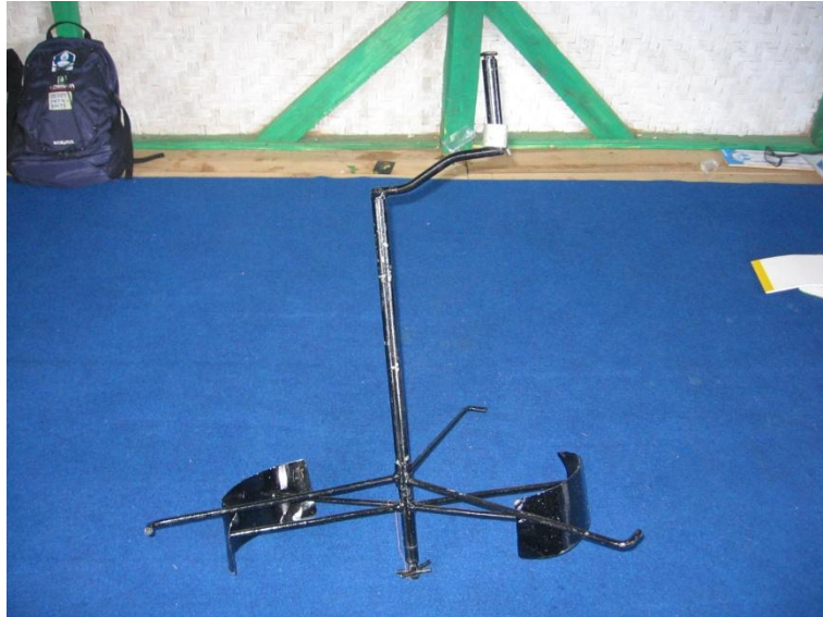
Gambar 123. Mixer untuk mengaduk pada pipa inlet
