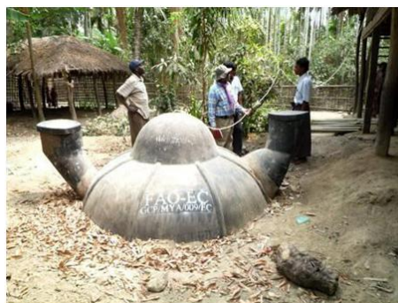
Gambar 32. Reaktor biogas dari besi
