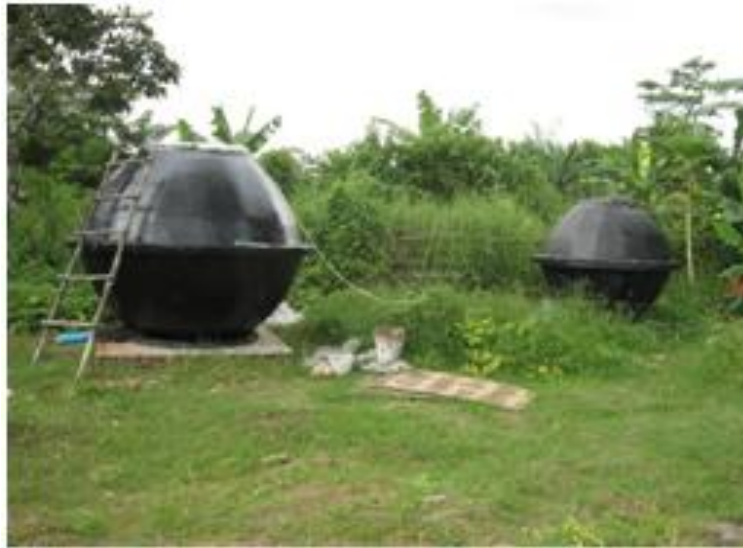
Gambar 30. Reaktor biogas dari bahan fibre glass
