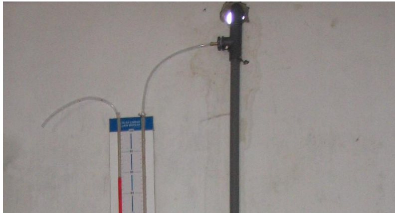
Gambar 162. Menghubungkan manometer dengan nipple
