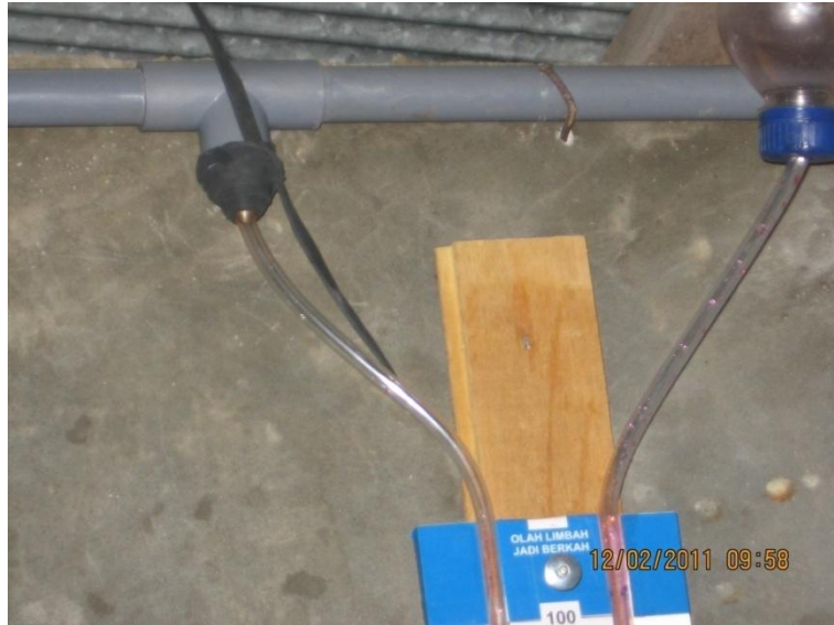
Gambar 168. Mengatasi kebocoran pada nipple untuk sementara
