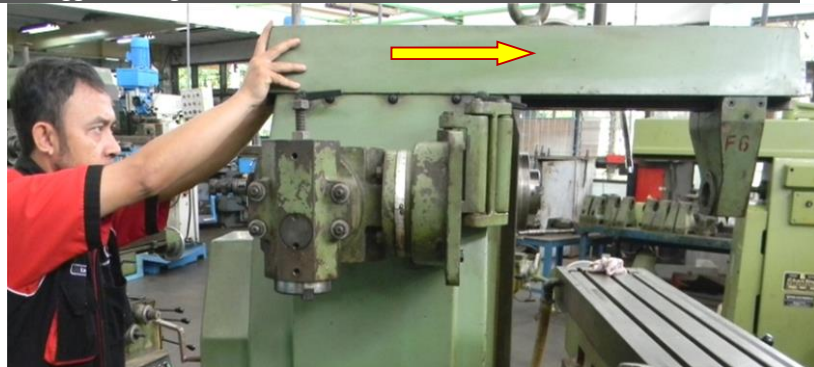
Gambar 3. 26 Menggeser lengan mesin
