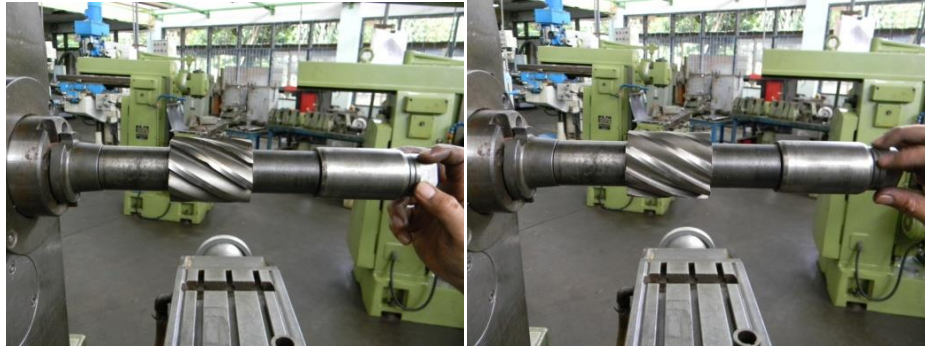
Gambar 3. 30 Pemasangan cutter dan kollar (ring arbor)
