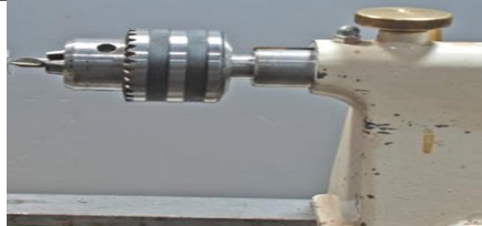
Pemasangan senter bor pada mesin bubut dan hasilnya
