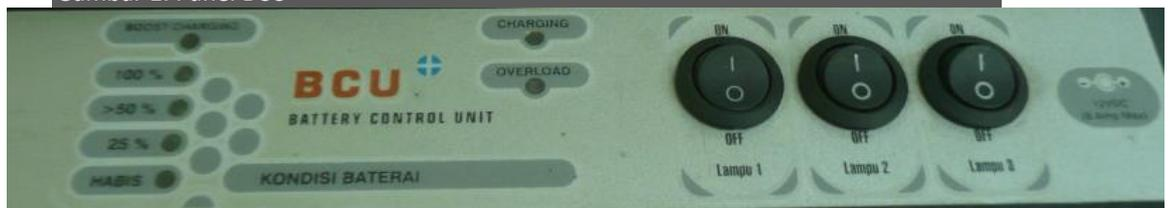
Ada tiga buah saklar yang masing-masing untuk Lampu 1, lampu 2, dan lampu 3.
