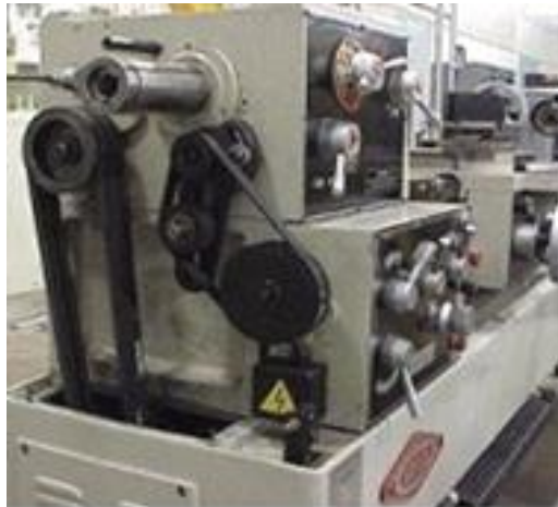
Gambar 2. 6 Gear Box Pada Kepala Tetap
