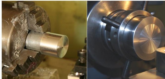
Gambar 2. 79 Pemasangannya Benda Kerja Berukuran Pendek Sebelum Dibubut Permukaannya
