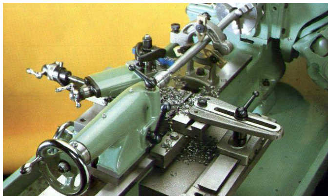
Pembubutan Lurus Benda Kerja Ditahan Dengan Senter Putar Dan Tengahnya Ditahan Dengan Steady Rest
