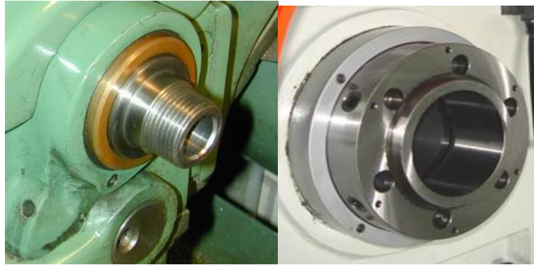
Gambar 2. 22 Cekam Terpasang pada Spindel Mesin
