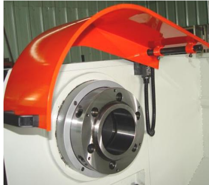
Kepala Tetap Terpasang Cekam (Chuck) Pada Spindle Utama Mesin Bubut
