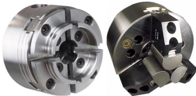
Gambar 2. 20 Cekam Dengan Rahang Untuk Pekerjaan Khusus
