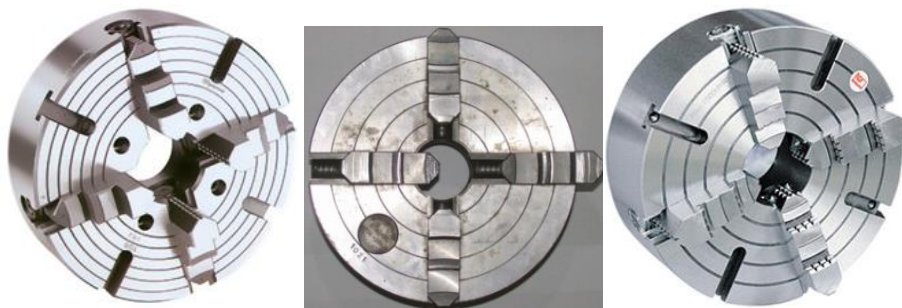
Gambar 2. 18 Cekam Rahang Empat Tidak Sepusat ( Independent Chuck )
