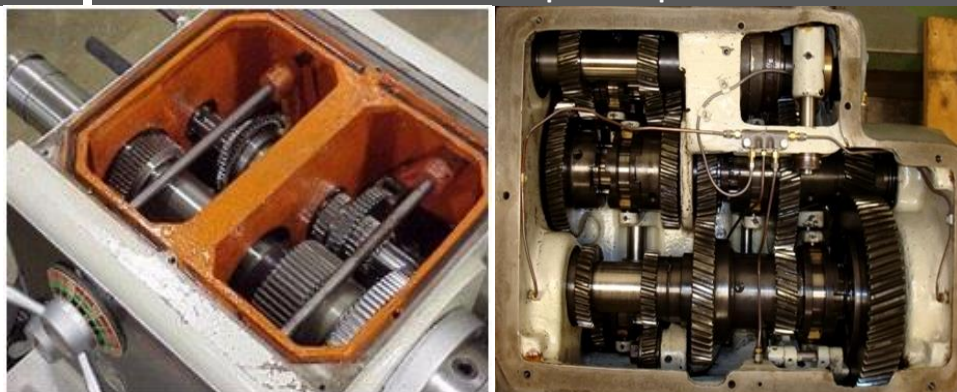
Gambar 2. 6 Gear Box Pada Kepala Tetap
