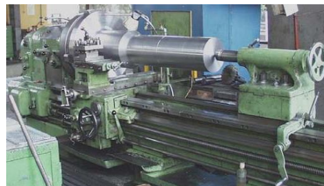
Pembubutan Lurus Benda Kerja Ditahan Dengan Senter Putar Dan Tengahnya Ditahan Dengan Steady Rest
