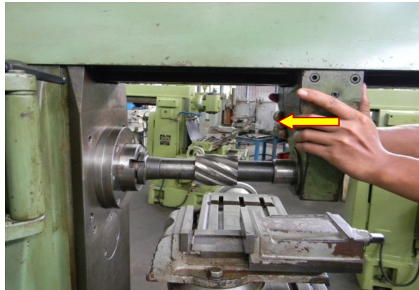
Pemasangan Pendukung Arbor
