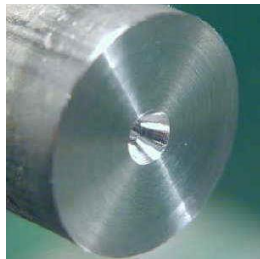
Gambar 2. 90 Dimensi bor senter (centre drill) dan hasil pembubutan lubang senter bor
