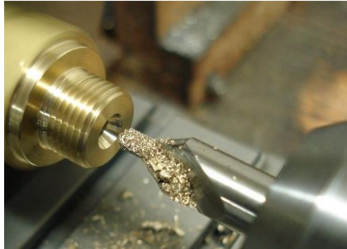
Gambar 2. 84 Pembubutan Lubang Senter Pada Permukaan Ujung Benda Kerja
