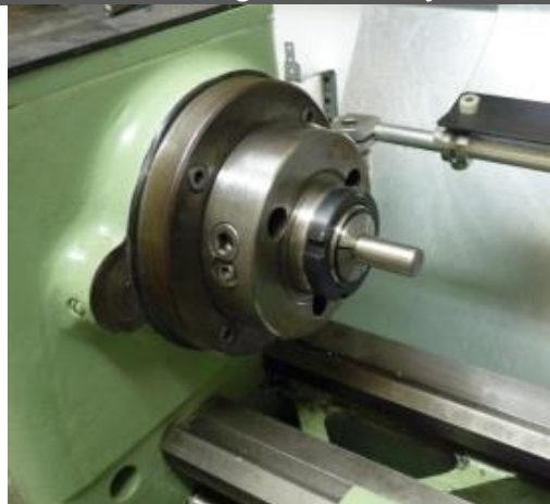
Gambar 2. 26 Pemasangan Benda Kerja Pada Kolet
