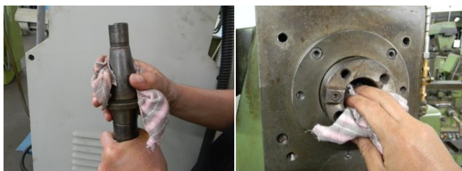
Gambar 3. 27 Membersihkan Arbor Dan Lubang Spindel Pada Bagian Tirusnya
