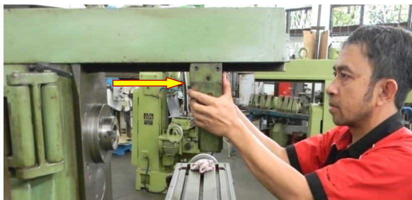
Gambar 3. 27 Membersihkan Arbor Dan Lubang Spindel Pada Bagian Tirusnya
