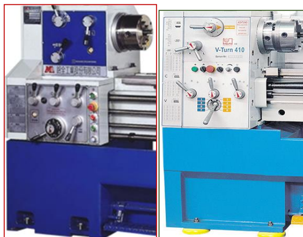
Tuas Pengatur Kecepatan dan Pengubah Arah Putaran Transportir
