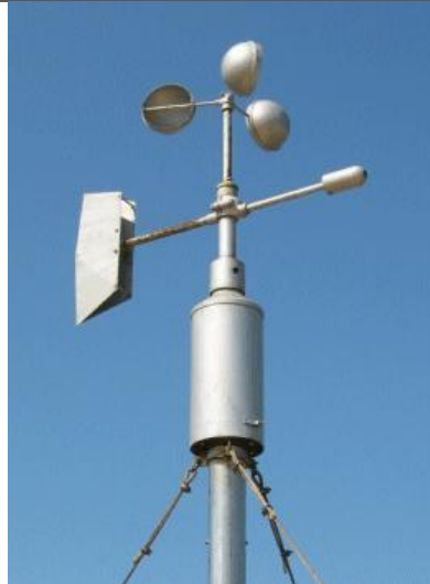
Anemometer dengan tiga mangkuk
