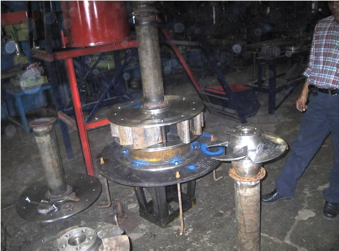
**Gambar 4. 18 Turbin propeller open flume buatan Lokal**
