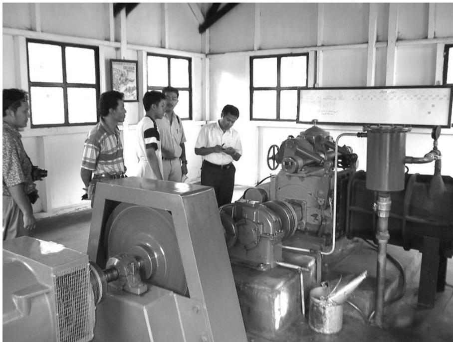
**Gambar 6. 7 Generator yang dihubungkan tidak langsung menggunakan gear box**
