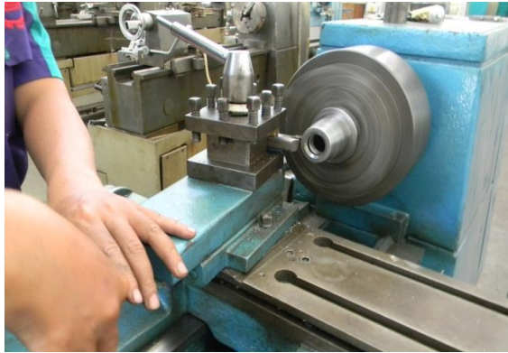
Gambar 2. 98 Pembubutan tirus dengan menggeser eretan atas
