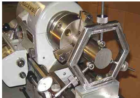
Gambar 2. 80 Pemasangannya benda kerja berukuran panjang sebelum dibubut permukaannya
