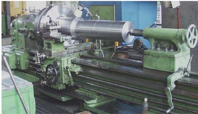
Gambar 2. 93 Pembubutan lurus, benda kerja ditahan dengan senter putar
