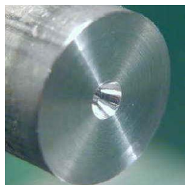
Gambar 2. 91 Dimensi bor senter (centre drill) dan hasil pembubutan lubang senter bor
