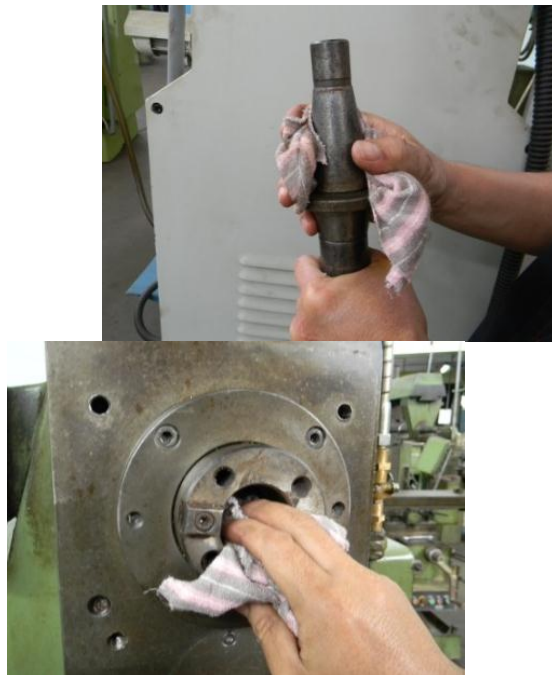
Gambar 3. 29 Membersihkan arbor dan lubang spindle pada bagian tirusnya
