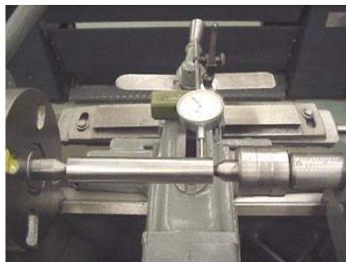
Gambar 2. 86 Mengatur kesepusatan sumbu dengan alat bantu batang pengetes dan dial indikator
