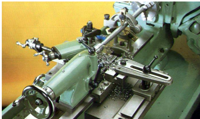
Gambar 2. 94 Pembubutan lurus benda kerja ditahan dengan senter putar dan tengahnya ditahan dengan steady rest
