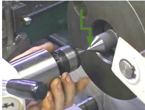
Gambar 2. 87 Mengatur keseputan sumbu senter dengan mempertemukan kedua ujung senter
