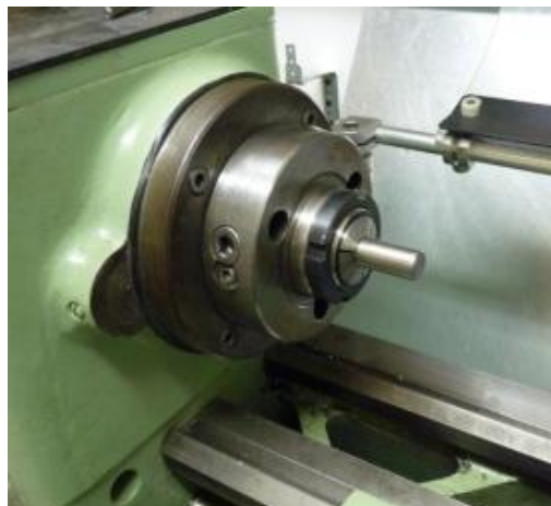
Gambar 2. 26 Pemasangan benda kerja pada kolet
