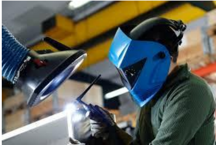
Gambar 4. 27 Contoh penggunaa penghisap asap
