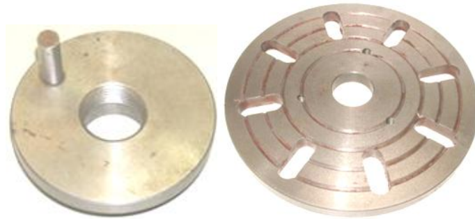
Gambar 2. 27 Pelat pembawa permukaan bertangkai dan Pelat pembawa rata
