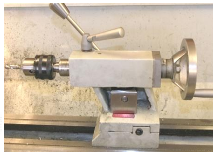
Gambar 2. 50 Pengikatan mata bor dengan cekam bor pada proses pembubutan
