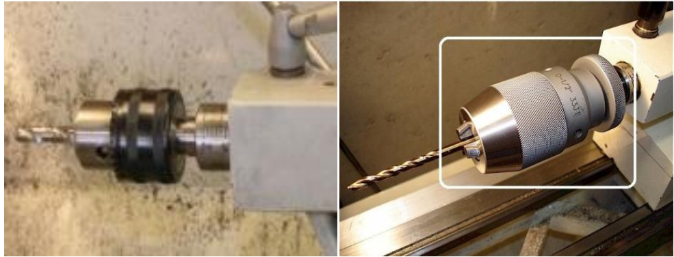
Gambar 2. 42 Pemasangan cekam bor
