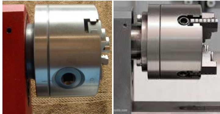
Gambar 2. 22 Cekam terpasang pada spindel mesin
