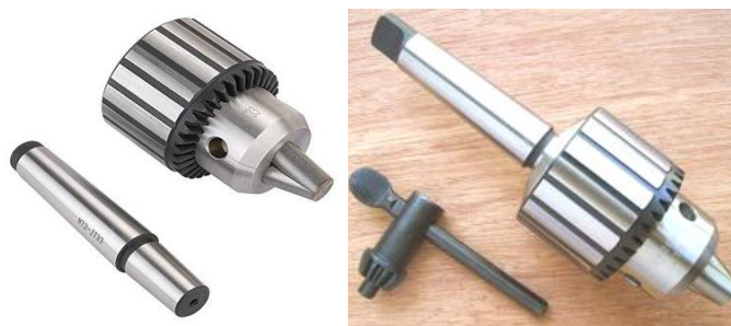
Gambar 2. 40 Cekam bor dengan pengunci
