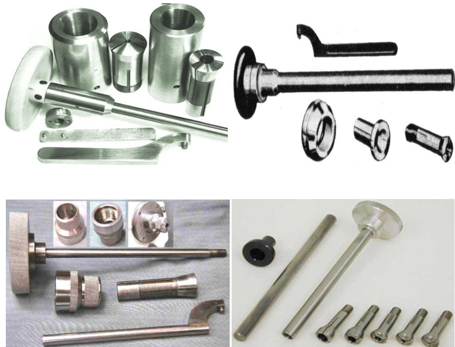
Gambar 2. 23 Cekam kolet dengan batang penarik
