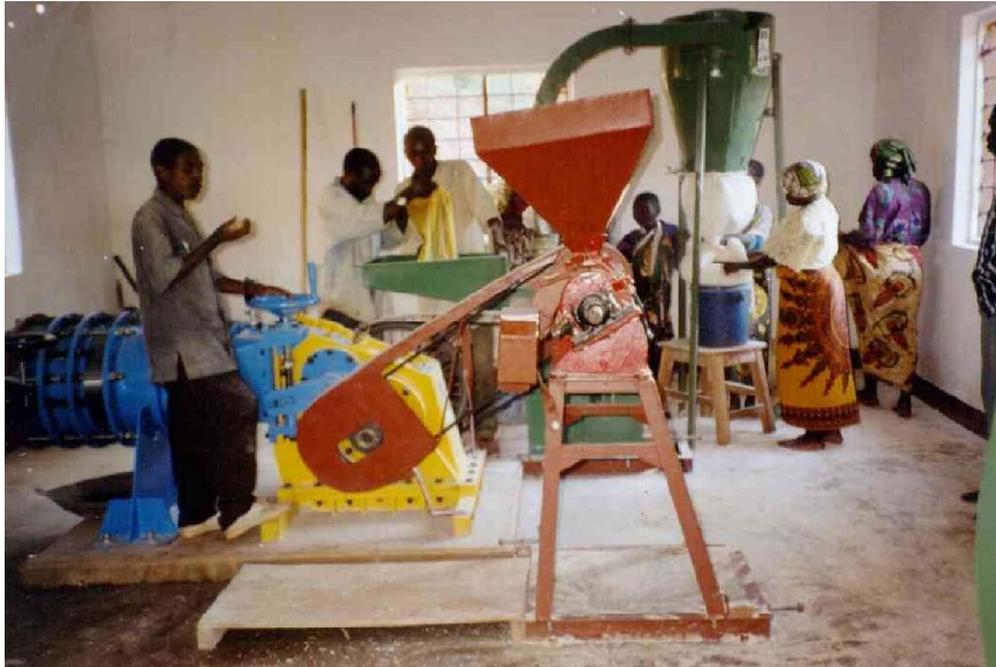
Gambar 2. 4 Poros turbin dikopel langsung dengan mesin penggilingan tepung (Tanzania)
