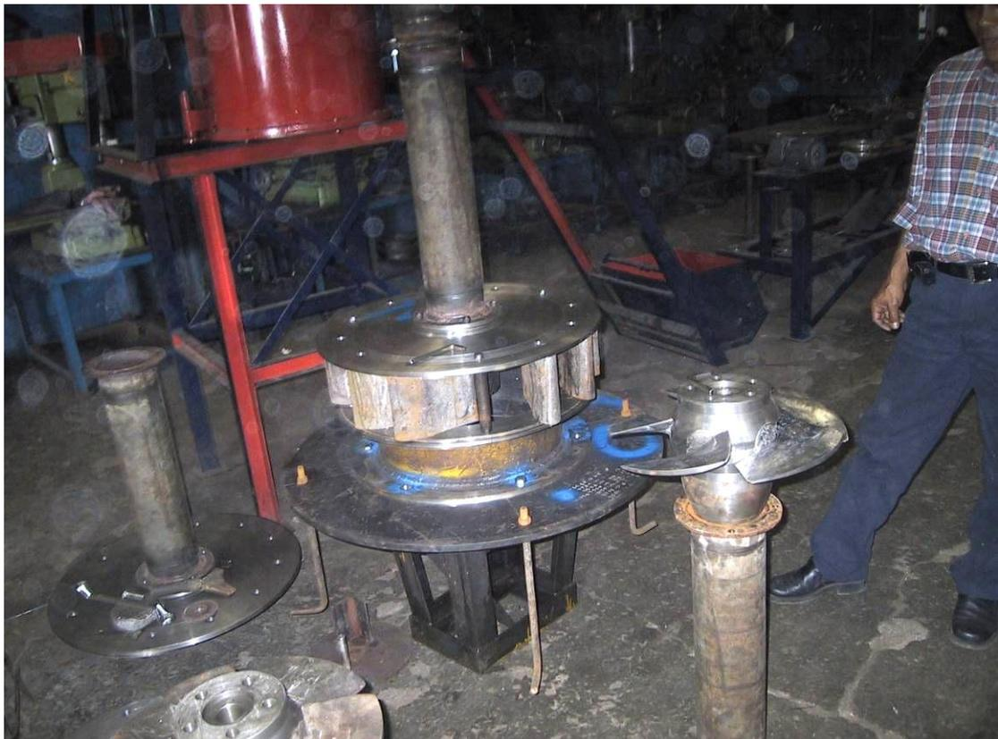
Gambar 2. 26 Turbin propeller open flume buatan Lokal
