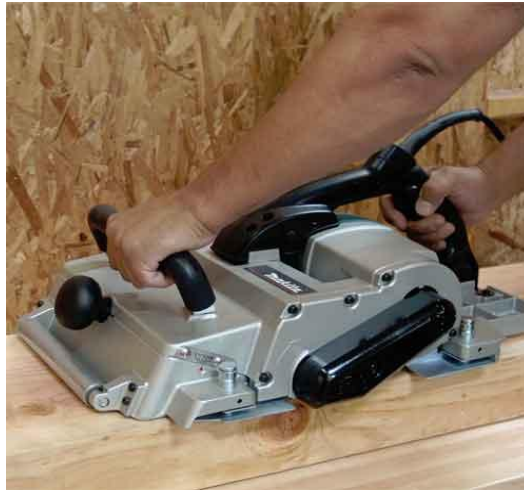
Gambar 3.13. Cara memegang mesin ketam
