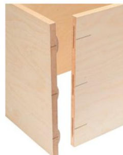
Gambar 7.26. Cara membuat sambungan konstruksi sudut
