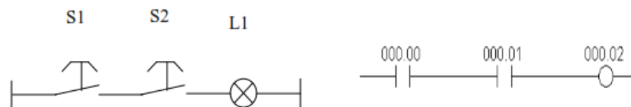
Gambar 30: a. Diagram rangkaian elektrik b. Diagram ladder
