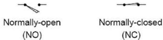
Gambar 2.11. Simbol dari Limit switch
