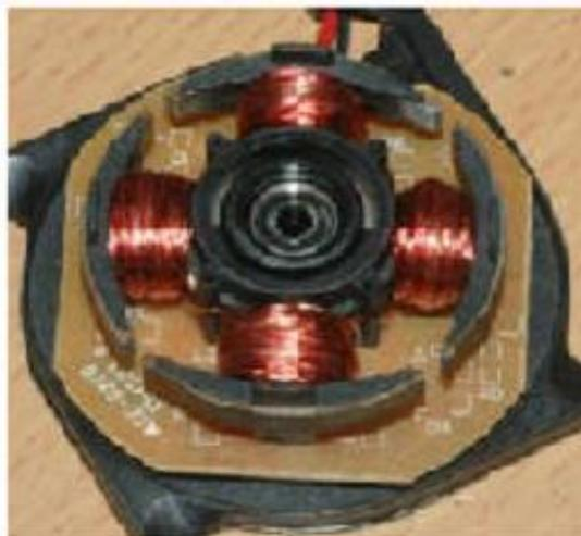
Gambar 2.40. Kutub pada stator motor DC brushless 2 fasa
