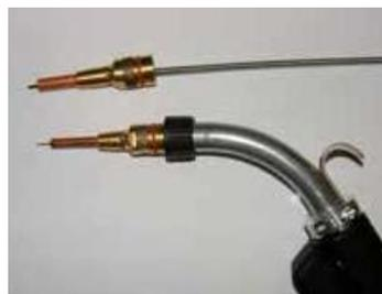
16) Memasang kembali cerobong gas dan memastikan dalam keadaan baik (tidak mengandung percikan, dan posisi ujung kontak dengan cerobong gas lurus)
