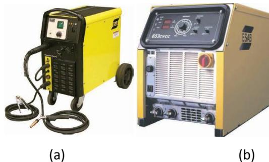
Proses GMAW dapat dioperasikan dengan menggunakan sumber tenaga/mesin las jenis *constant voltage* maupun mesin las jenis *constant current*. Sumber tenaga/mesin las untuk GMAW diklasifikasikan berdasarkan karakteristik tegangan dan arus, sehingga dikenal dua jenis mesin las yakni mesin las voltase konstan/konstan potensial (*Power Source Constant Voltage*) dan mesin las arus konstan/variable voltase (*Power Source Constant Current*). Meskipun demikian,
