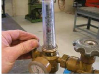
20) Memeriksa “O” ring untuk memastikan bahwa aliran gas tidak bocor.
