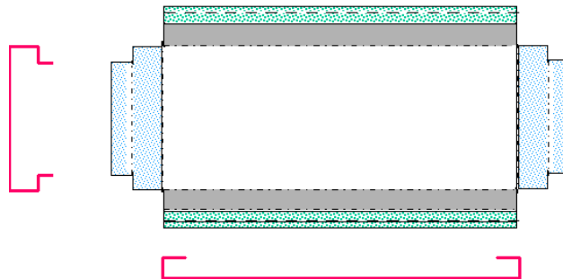
Bentangan tiga tekukan berlawanan arah empat sisi
