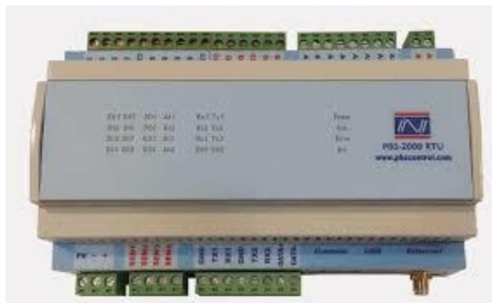
Gambar 2. RTU yang dilengkapi dengan I/O Digital
