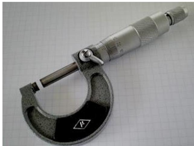
**Gambar 11 Mikrometer Sekrup**
