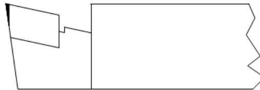
Gambar 65 Keausan pada bidang bebas muka pahat bubut
