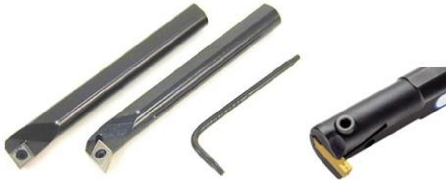
Gambar 53 Pahat bubut sisipan pengikatan diklem/ dibaut terpasang pada pemegangnya untuk pembubutan bagian dalam
