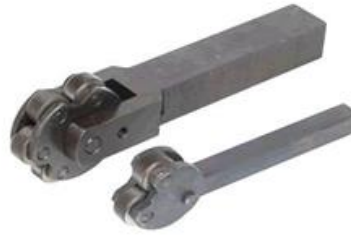
Gambar 117 Pemegang gigi pisau kartel lurus dengan posisi tetap/ rigid
