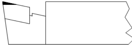
Gambar 66 Keausan pada bidang potong pahat bubut
